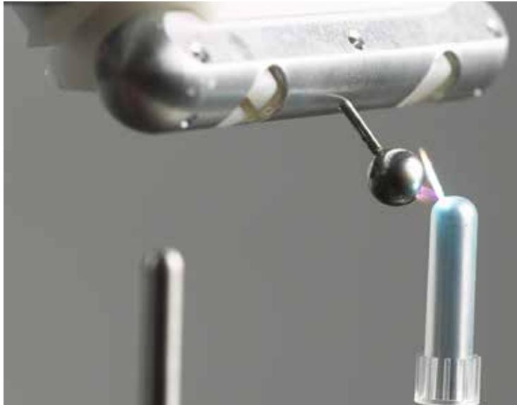
**LeakTEC ist ein leistungsfähiges Werkzeug für die zerstörungsfreie Dichtigkeitsprüfung an nicht leitenden einschichtigen Materialien. Das System LeakTEC misst ein Loch zwischen einer Hochspannungselektrode (DC) und einer Gegenelektrode, die entweder geerdet oder mit umgekehrter Polarität angeschlossen sein kann. Das System LeakTEC stellt die vollständige Prozesssteuerung und Nachverfolgbarkeit sicher.**
